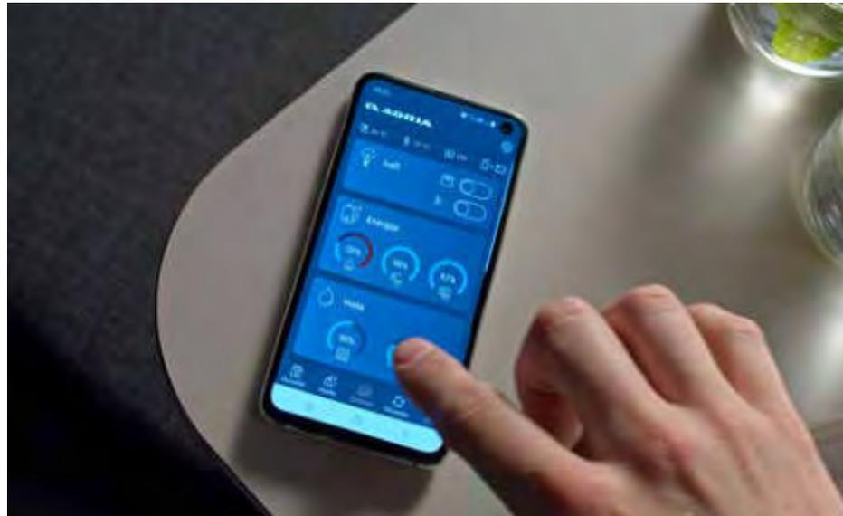
**MACH Basic** nutzt Bluetooth® für die **lokale Steuerung** der wichtigsten Funktionen (Bedienfeld, Heizung, Klimaanlage\*, Kühlschrank, Wasserpumpe, Wassertankstände und Batteriestatus). MACH Basic liefert zudem ein individualisiertes Benutzerhandbuch, Nivellierungsinformationen (Winkel-Beschleunigungssensor) und wichtige technische Daten.
